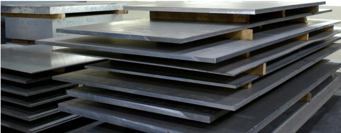
O alumínio Naval 5052-F dispõe de uma excelente usinagem e estabilidade, com uma dureza entre 40 e 50HB, variável conforme espessura, sendo muito utilizado em pequenas produções.
